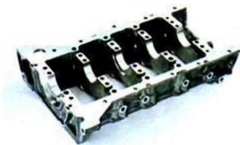
Рис. 1.6. Рама лестничного типа в блоке.
